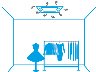
Rozkład powietrza z zabrudzonym filtrem
